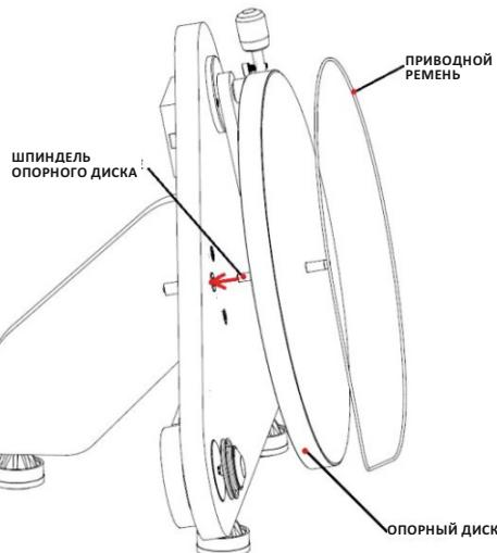
**После установки пластиинки на опорный диск необходимо затянуть фиксатор грампластиинок (6) на шпинделе опорного диска.**
