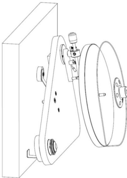
**После установки пластинки на опорный диск необходимо затянуть фиксатор грампластинок (6) на шпинделе опорного диска.**
