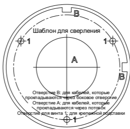
Рисунок 2-4 Шаблон для сверления распределительной коробки
