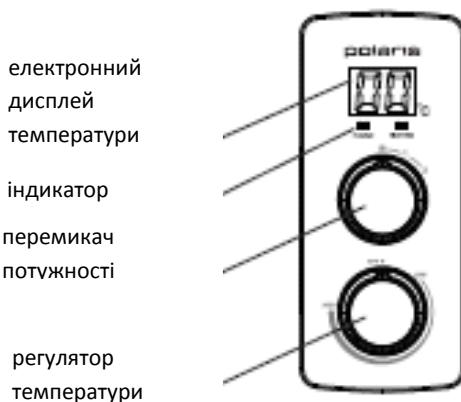
1. За допомогою перемикача потужності встановіть необхідну потужність (1500Вт /2500Вт). Від вибору потужності залежить швидкість (час) нагрівання води до заданої температури. При вмиканні перемикача потужності в позицію «1» прилад працює з потужністю 1500Вт. При вмиканні перемикача потужності в позицію «2», прилад працює з потужністю 2500Вт. Індикаторна лампочка, що світиться, означає нагрівання води.
