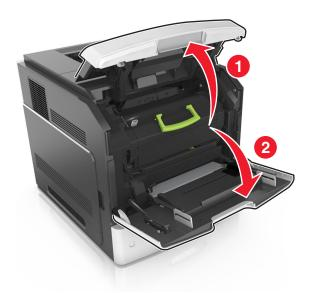
2 Поднимите зеленую рукоятку и извлеките картридж с тонером из принтера.
