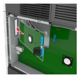
**Примечание.** Расположите порт ISP под углом к пластмассовой вставке, чтобы все свешивающиеся разъемы прошли через отверстие ISP в каркасе системной платы.
