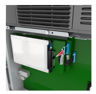
**4** Совместите зазоры жесткого диска принтера с отверстиями порта системной платы, затем нажмите на жесткий диск принтера, чтобы зазоры встали на место.
