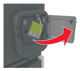
2 Нажмите на фиксатор держателя кассеты со скобами и выньте держатель из брошюровщика.
