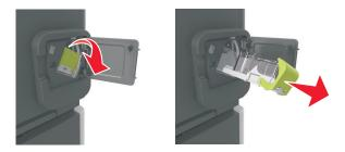
**4** С помощью металлической скрепки поднимите ограничитель прошивочных скоб и удалите все выпавшие скрепки.
