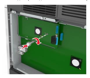
**Примечание.** Поверните винт по часовой стрелке, достаточно для того, чтобы закрепить ISP на месте, но не затягивайте его.
