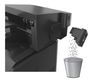
3 Установите бункер отходов перфорации на место в брошюровщик, нажав на него до щелчка.
