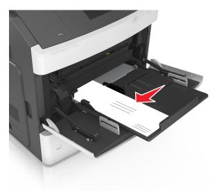
**ПРЕДУПРЕЖДЕНИЕ. Возможность повреждения:** Запрещается печатать на конвертах с марками, застежками, защелками, окнами, рельефным покрытием и самоклеящимися полосками. Такие конверты могут серьезно повредить принтер.
