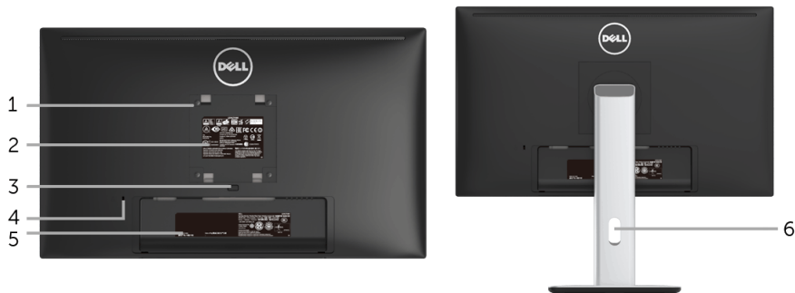
Вид сзади (с установленной стойкой)
