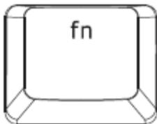
Нажатие клавиши FN в сочетании с функциональными клавишами активирует их второстепенные задачи на вашем ПК. В Mac OS X нажимать клавишу FN для включения второстепенных задач не нужно, но для их использования придется сначала установить Razer Synapse.
