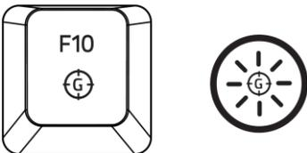
Включив игровой режим, вы сможете менять первостепенную функцию, выбирая между мультимедийными или функциональными клавишами. При включении игрового режима загорается индикатор. Для отключения игрового режима достаточно нажать клавишу игрового режима.
