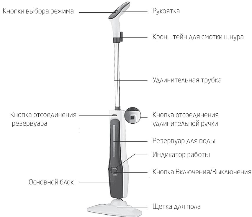
Рукоятка и удлинительная трубка, собранные вместе, образуют удлинительную ручку. На рукоятке расположены кнопки выбора режима подачи пара и индикаторы. Батарейный отсек находится с нижней стороны рукоятки.
