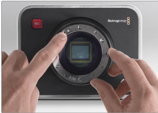
4 단계. 핀에 장착되어 있던 기존 0.50mm 심의 11시 방향 위치를 기억해둡니다.
