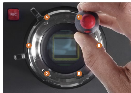
ステップ 8. トルクレンチを使い、ネジAを1度フル回転させます。同様にネジB、C、D、E、Fを順に回転させていきます。1度に1回転ずつ上記の順序で締めていき、すべてのネジが最大許容0.45Nmトルクに締まるまでこの作業を続けます。
