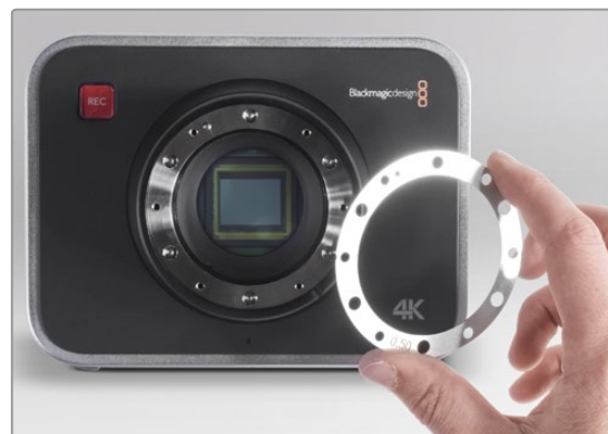
ステップ 5. 装着されている0.50mmシムを取り外します。レンズの焦点標示を焦点距離と合わせるために必要となる厚さのシムを装着します。
