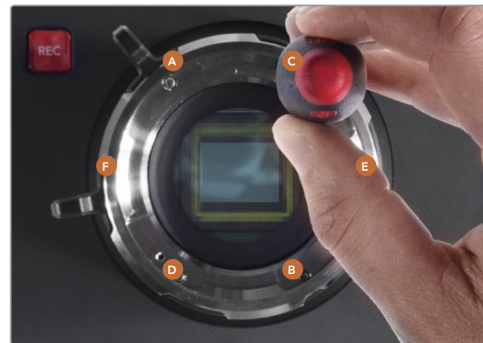
8 단계. 토크 렌치를 사용하여, 마운팅 나사 A를 한 바퀴 돌려 조인 후, 나사 B, C, D, E, F도 같은 방법으로 반복합니다. 같은 방식으로 나사를 차례대로 한 번씩 돌려 모든 나사가 최대 토크 0.45Nm에 이를 때까지 조입니다.
