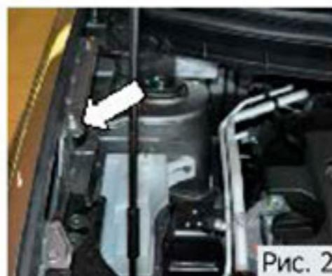
2. Установить болт-шарнир с двумя шайбами 6 вместо штатного болта крепления крыла. Затянуть болт-шарнир торцевой головкой №10 с усилием 9 Нм, (Рис.2).
