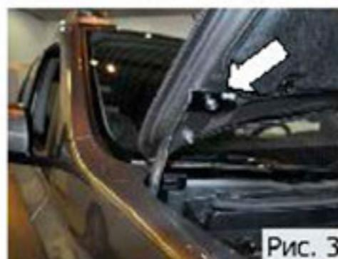
3. Открутить верхнюю гайку крепления капота торцевой головкой №13. Установить кронштейн капота, уперев его в ребро жесткости. Зафиксировать кронштейн гайкой специальной с шайбой 10. Затянуть гайку специальную торцевой головкой №13 с усилием 23 Нм, (Рис.3).
