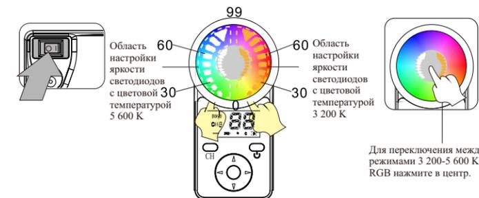
В режиме 3200-5500K настройка яркости цветовой температуры выполняется в направлении, указанном стрелкой. В режиме RGB настройка яркости выполняется непосредственно с помощью сенсорной кнопки.
