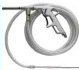
для средних объёмов работ. Твердосплавное сопло 6 мм., шланг забора смеси 3 м., диам. 8x13 мм рабочее давление :5-8 бар, расход воздуха: более 400 л/мин
