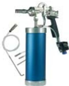
для нанесения составов типа Body. Бачок 1 л. под давлением, 4 трубки по 90 см. с соплами различной формы для обработки полостей. Регулировка распыла. Рабочее давление 5-8 бар.
