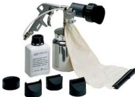
Пескоструйный набор для небольших объёмов работ. Имеет систему активного сбора отработанной абразивной смеси. В комплекте: абразивная смесь 0,7 кг., и 4 фигурных резиновых насадки для обработки криволинейных поверхностей, наружных и внутренних углов и пр. Рабочее давление 5-8 бар, расход воздуха более 300 л/мин.
