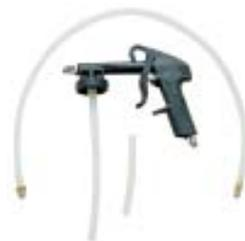
насадка для нанесения антигравия, резьба под стандартную ёмкость, трубка 60 см. с бронзовым соплом для обработки полостей. Корпус-Моплен. Рабочее давление 2,5-5 бар.
