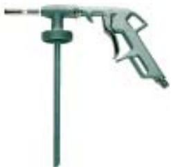
цельноалюминиевая насадка для нанесения антигравия, резьба под стандартную ёмкость, трубка 60 см. с соплом для обработки полостей. Рабочее давление 2-5 бар.
