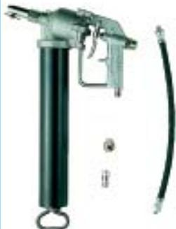
шприц-нагнетатель расфасованных консистентных смазок под давлением до 600 бар. Ручная подача материала, шланг-штуцер 40 см с соплами "Zerk" и "Calamit". Рабочее давление 4-5 бар.
