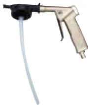
насадка для нанесения антигравия, резьба под стандартную ёмкость, трубка 60 см. с соплом для обработки полостей, запасная крышка. Упаковка- блистер. Рабочее давление 2-5 бар.
