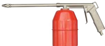
моющий пистолет, стальной нижний бачок ёмкостью 1 л. Воздуховод 200 мм. Сопло с регулировкой степени распыла.
