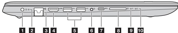
**1 Гнездо адаптера питания** Предназначено для подключения адаптера питания.
