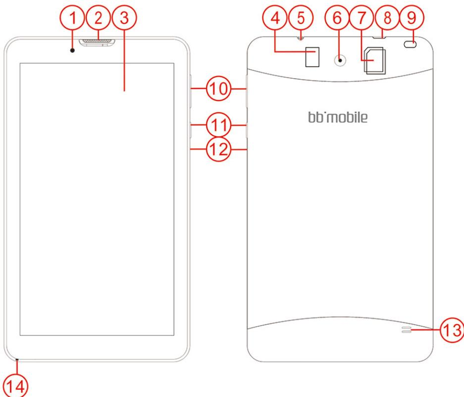
**12. Кнопка Reset.** Предназначена для экстренного выключения устройства.
