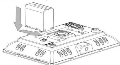
Чтобы снять батарею, нажмите на клавишу фиксации и сдвиньте батарею в обратном направлении.
