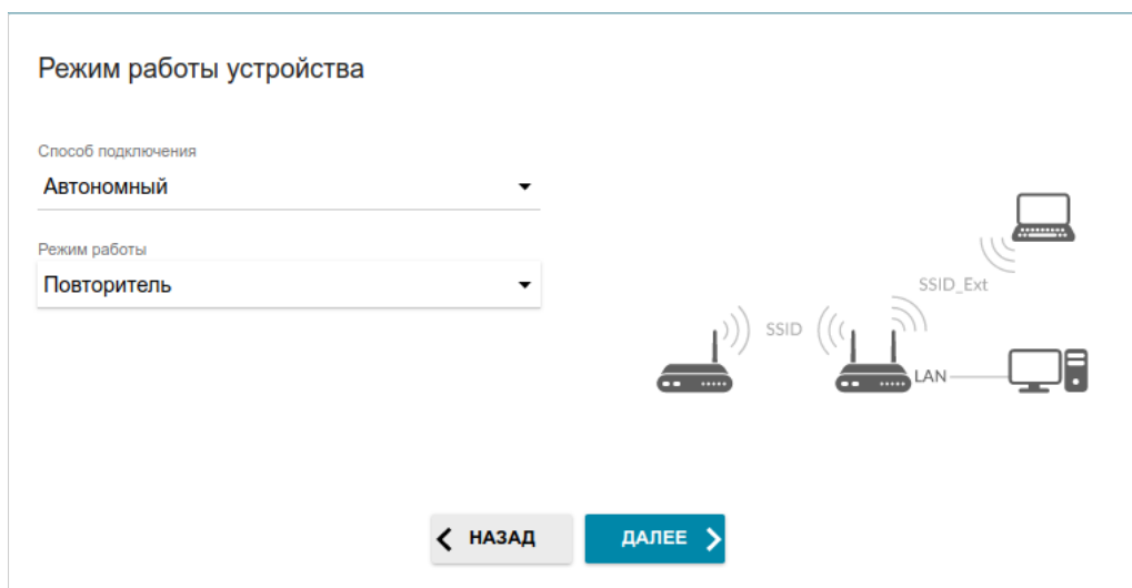
Рисунок 36. Выбор режима работы устройства. Режим Повторитель.
