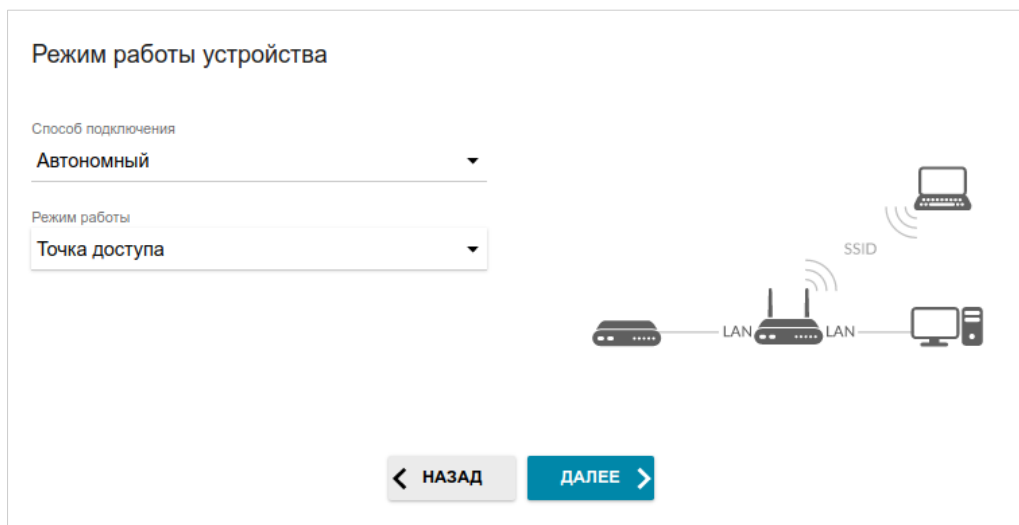
Рисунок 35. Выбор режима работы устройства. Режим Точка доступа.
