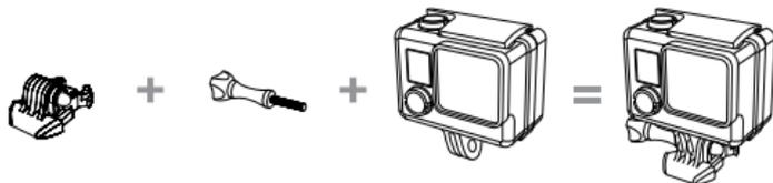
Быстросъемное крепление + Фиксирующий винт + Корпус = Устройство в сборе
