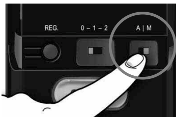
Установка режима ручного запираения
