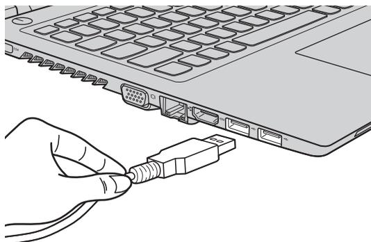
При первом подключении устройства USB к одному из USB-портов компьютера ОС Windows автоматически устанавливает драйвер для данного устройства. После установки драйверов устройство можно подключать и отключать без каких-либо дополнительных действий.
