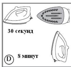
Үтікті автоматты сөндіру функциясы келесідей тәсілмен жүзеге асады: Белгілі бір температурага дейін қыздырылған, бірақ, қолданылмаған үтік, сондай-ақ, табанында жатқан немесе бір қырынан жатқан үтік 30 секундтан кейін автоматты түрде сөнеді. Егер үтік пайдаланылмаса және таяныш-тіректі тігінен тұрса, - автоматты түрде сөну режимі 8 минуттан кейін қосылады ( D сурет). Үтік автоматты түрде өшкен кезде дыбыстық сигнал естіледі.
