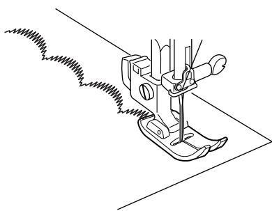
Определите необходимую плотность стежков на пробной полоске ткани.
