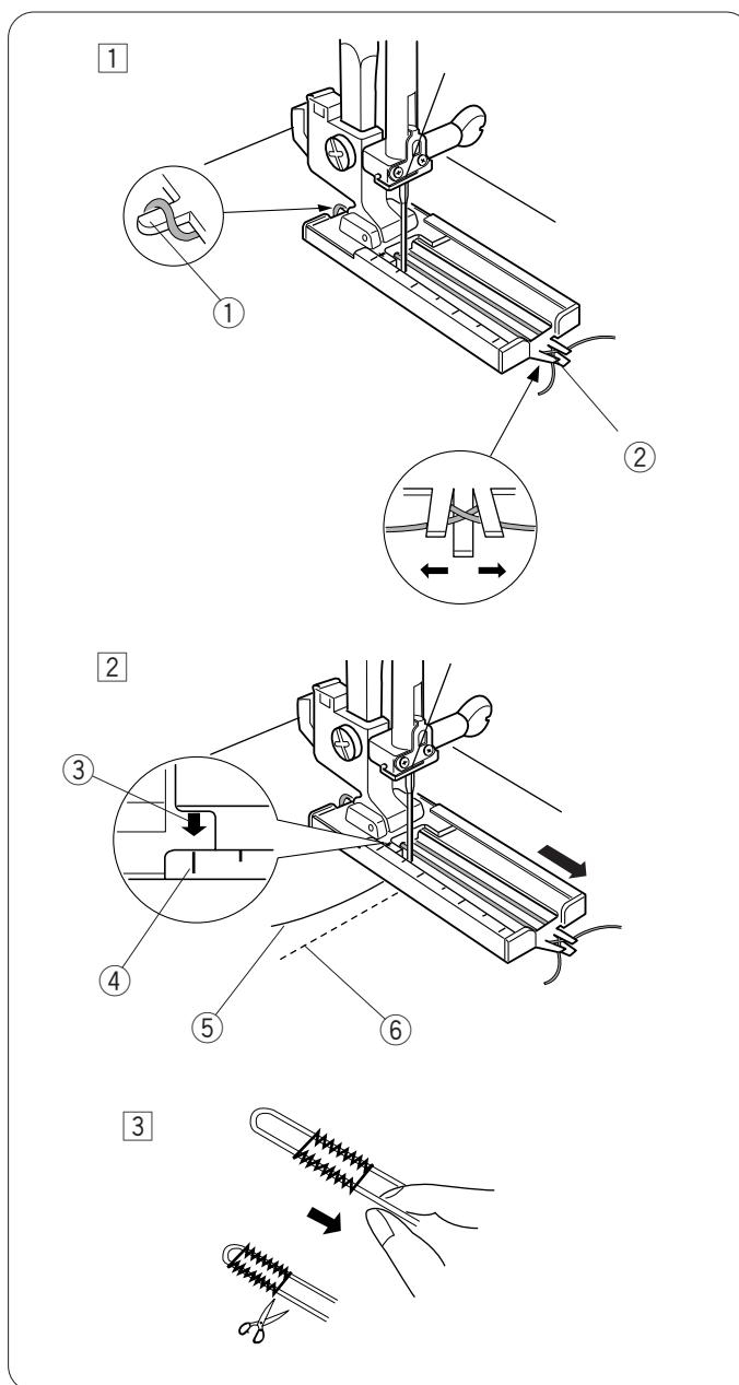
① Поднимите лапку для автоматической петли, набросьте шнур на крючок сзади лапки. Переведите концы шнура вперед, заправив под лапку. Зацепите шнур в вилке впереди лапки, чтобы натянуть его.
