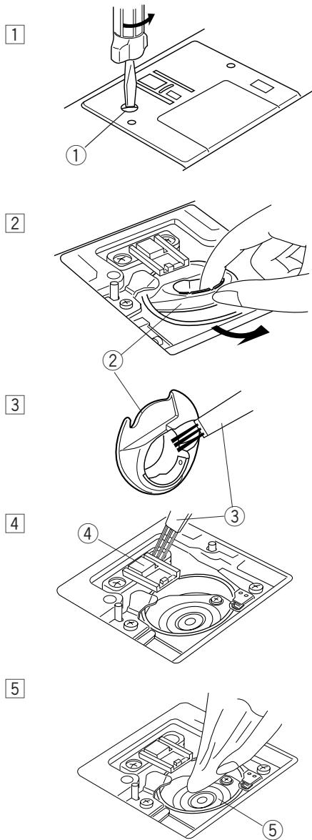
1 Снимите прижимную лапку и иглу. При помощи отвертки удалите винт игольной пластины.
