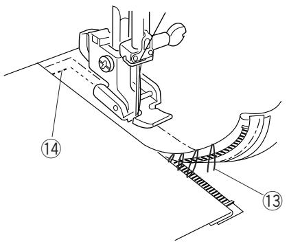
5 Поднимите лапку. Снимите ее и переставьте на левую сторону.
