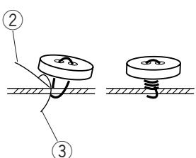
Удалите нить из иглы. Измените ширину зигзага так, чтобы игла сквозь прорезь на лапке попадала в отверстия пуговицы. Поверните маховое колесо и проверьте, входит ли игла в отверстия пуговицы. Опустите прижимную лапку, чтобы закрепить пуговицу на месте.
