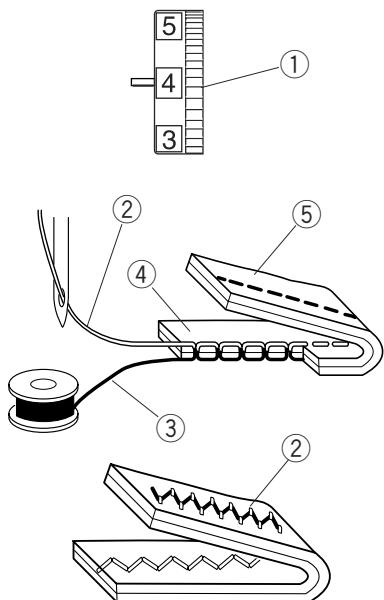
Натяжение нити при шитье устанавливается в зависимости от обрабатываемой ткани, количества слоев и других различных условий. Для изменения натяжения нити поверните диск натяжения нити.
