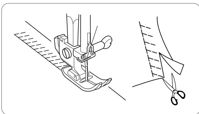
Этот стежок идеален для работы с трикотажем или средними тканями для создания узкого шва. Также он хорош для обработки купальных костюмов из спандекса. Разложите ткань, оставив 1.6 см на припуск. После создания шва отрежьте излишнюю ткань с краю.
