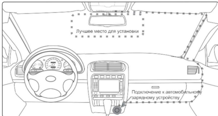
Разместите устройство в области зеркала заднего вида, чтобы обеспечить наилучший обзор.
