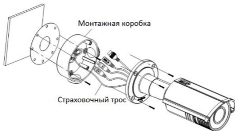
Рисунок 2-13 Установка с монтажной коробкой
