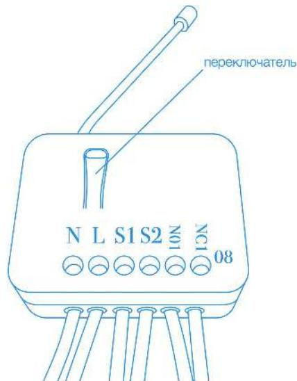
**Рис. 5 Переключатель режима добавления/удаления устройства**
