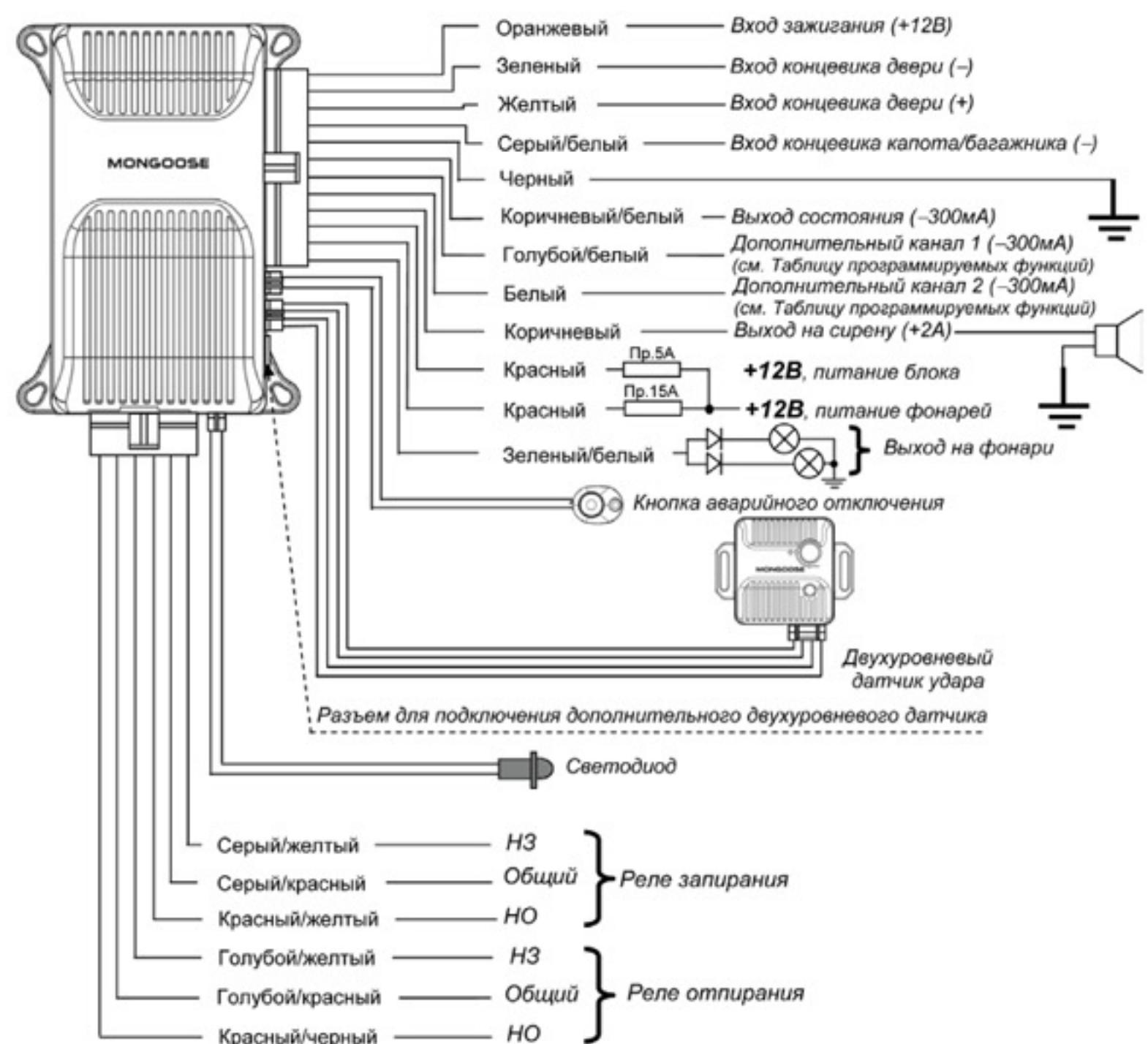
**Назначение проводов и разъемов центрального блока.**
