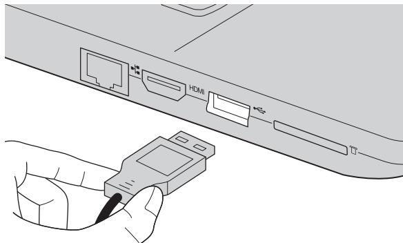
При первом подключении устройства USB к одному из USB-портов компьютера ОС Windows автоматически устанавливает драйвер для данного устройства. После установки драйверов устройство можно подключать и отключать без каких-либо дополнительных действий.
