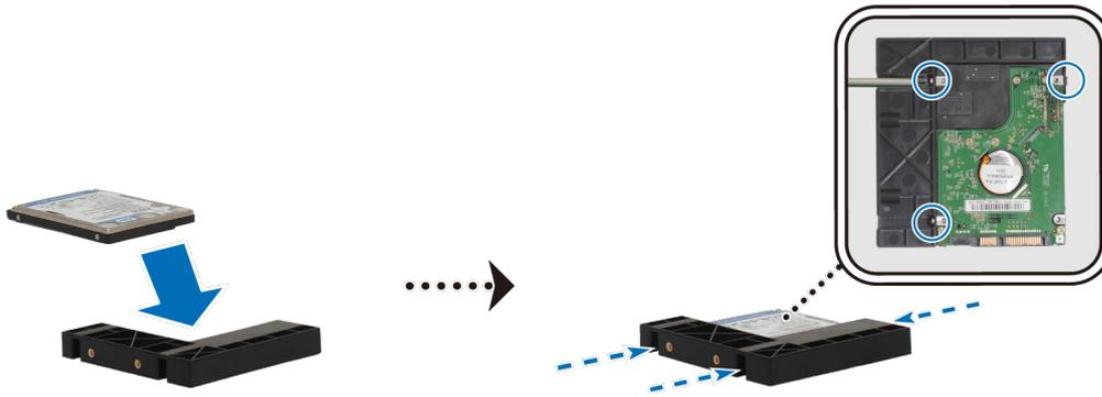
**b** Установите держатель дисков 2,5 дюйма в отсек для дисков и продвиньте вперед, пока диск не подключится к разъему SATA. Зафиксируйте держатель с помощью шурупов, включенных в комплект поставки.
