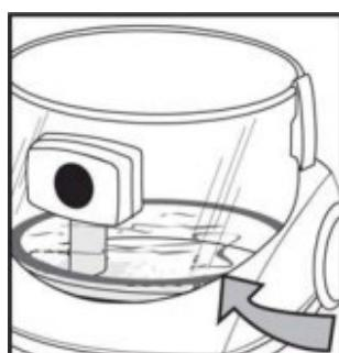
2. Налейте в резервуар для воды (E) 3,2-3,5 л холодной водопроводной воды так, чтобы уровень ее на 0,5-1 см закрыл нижний край внутреннего патрубка входного отверстия (F).
