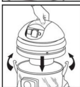
4. Установите блок двигателя (C) на резервуар для водяного фильтра (E) и закрепите его с двух сторон фиксирующими клипсами до щелчка.
