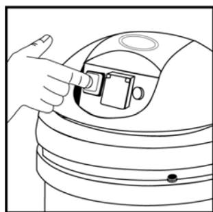
**ВИМАНИЕ:** По окончании пользования пылесосом или перед проведением чистки или обслуживания аппарата необходимо выключить прибор кнопкой включения/выключения (A) и отключить прибор от электрической сети.
