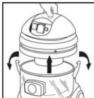
1. Отстегните клипсы крепления на резервуаре для воды (E). Отсоедините блок двигателя (C) от резервуара для водяного фильтра (E).
