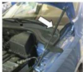
4. Прокатать амортизатор (упереть в твердую поверхность, несколько раз полностью сжать и отпустить).
