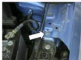
2. Установить болт-шарнир с шайбой на крыло как показано на рисунке. Затянуть болт ключом №10 с усилием 9 Нм.
